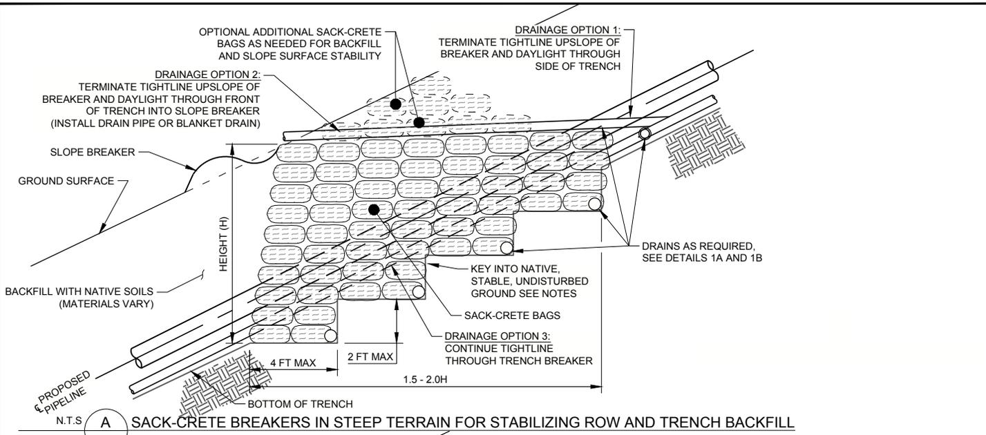
**A SACK-CRETE BREAKERS IN STEEP TERRAIN FOR STABILIZING ROW AND TRENCH BACKFILL**
