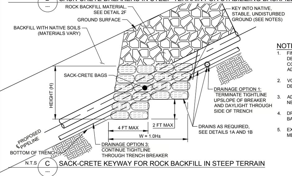
**C SACK-CRETE KEYWAY FOR ROCK BACKFILL IN STEEP TERRAIN**
